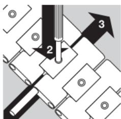
Com a ferramenta auxiliar inclusa, empurre agora o pino de fixação para baixo (2), empurrando ao mesmo tempo o pino articulado para dentro até ficar nivelado com a bracelete (3). O pino de fixação tem de ser movido novamente para cima até ficar alinhado com a borda superior do elo de bloqueio. Verifique impreterivelmente o assento correto do pino articulado. Guarde os elos excessivos e a ferramenta de separação num lugar seguro para possíveis adaptações posteriores.
