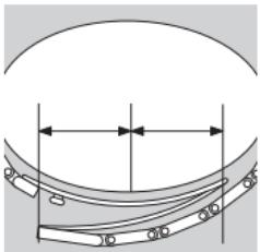
Legen Sie die Uhr mit geschlossener Falt-schliesse um Ihr Handgelenk und schätzen Sie anhand der Überlappung die Anzahl der überzähligen Bandglieder ab, die Sie nun, wie im Folgenden beschrieben, herausnehmen können: Müssen Sie mehrere Glieder entfernen, empfehlen wir, von beiden Seiten des Bandes die möglichst gleiche Anzahl Bandglieder herauszunehmen, sodass der Verschluss ungefähr in der Mitte des Handgelenks getragen werden kann.
