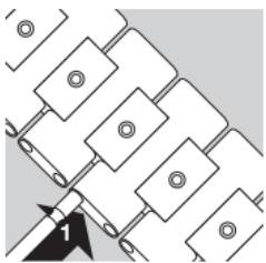
Ripeta le operazioni da 1 a 3 alla distanza precedentemente stabilita dal primo punto di giunzione. Estragga le maglie staccate e ricongiunga il bracciale accorciato. Inserisca il perno di snodo lateralmente nel punto di giunzione (1).
