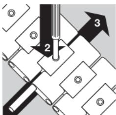
Au moyen de l'outil spécial fourni, enfoncez maintenant la cheville de fixation vers le bas (2) tout en réinsérant l'axe d'articulation dans le bracelet, en prenant soin de bien l'aligner (3). La cheville de fixation doit à nouveau affleurer le bord supérieur du maillon de sécurité. Vérifiez pour finir le bon ajustement de l'axe d'articulation. Veuillez conserver précieusement les maillons surnuméraires et l'instrument de séparation pour une éventuelle adaptation ultérieure.
