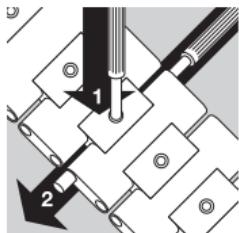
Abra el cierre desplegable apretando los pulsadores laterales. Coloque el brazalete sobre una base firme con su parte exterior hacia abajo. Para evitar que el brazalete y la base se rayen, coloque un paño por debajo. Con la herramienta adjunta, podrá presionar hacia abajo el perno de fijación en el punto de separación deseado (1) y, con la segunda herramienta, empujar simultáneamente el perno articulado unos 3 milímetros hacia fuera (2).
