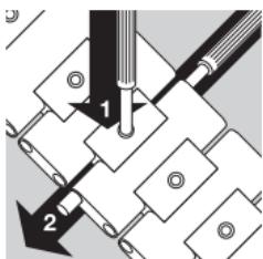
Öffnen Sie die Faltschliesse durch Drücken der seitlichen Tasten. Legen Sie das Band mit der Aussenseite nach unten auf eine feste Unterlage. Um ein Verkratzen von Band und Unterlage zu vermeiden, sollte ein Tuch untergelegt werden. Mit dem beiliegenden Hilfswerkzeug können Sie nun an der gewünschten Trennstelle den Fixierbolzen hinunterdrücken (1) und dabei den Gelenkbolzen mit dem zweiten Hilfswerkzeug seitlich etwa 3 Millimeter hinausschieben (2).
