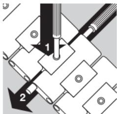
Abra o fecho de engate premindo as teclas laterais. Coloque a bracelete em cima de uma base firme, com o lado exterior virado para baixo. Para evitar arranhaduras na bracelete ou na base, convém meter um pano debaixo da bracelete. Com a ferramenta auxiliar inclusa, poderá agora empurrar o pino de fixação para baixo no ponto de separação pretendido (1), deslizando ao mesmo tempo, com a segunda ferramenta auxiliar, o pino articulado cerca de 3 milímetros para fora (2).
