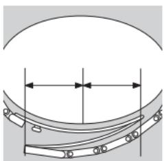
Meta o relógio em torno do seu pulso com o fecho de engate fechado e estime o número de elos excessivos sobrepondo as pontas da bracelete. Remova depois os elos excessivos, conforme descrito a seguir. Se precisar de reduzir o comprimento por vários elos, recomenda-se que remova o mesmo número de elos nas duas pontas da bracelete, de modo a garantir que o fecho fique mais ou menos no meio do pulso.
