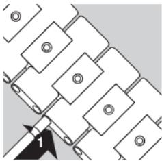
Wiederholen Sie die Schritte 1 bis 3 im soeben ermittelten Abstand von der ersten Trennstelle. Entfernen Sie die freigelegten Bandglieder und fügen Sie das verkürzte Band zusammen. Schieben Sie den Gelenkbolzen seitlich in das Armband ein (1).
