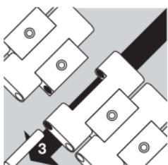
Ziehen Sie den vorstehenden Gelenkbolzen aus dem Armband (3). Jetzt ist das Band getrennt.
