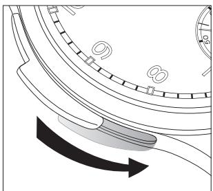
Betätigen Sie den Repetitionsschieber, wie in der Abbildung gezeigt. Der Schieber muss immer bis zum Anschlag gedrückt werden, da sonst keine Auslösung erfolgt. Hierdurch wird eine Fehlinformation vermieden (Alles-oder-nichts-Prinzip). Danach den Schieber wieder zurückgleiten lassen.
