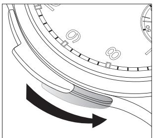
Accione la corredera de la repetición tal como se muestra en la imagen. La corredera tiene que presionarse hasta el tope, pues de lo contrario no se activará. Evitará así crear una falsa información (principio de «todo o nada»). Tras ello, regrese la corredera a su posición normal.
