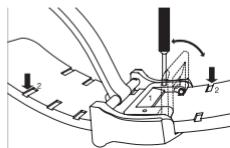
将表链放在一个牢固的底座上, 上表面朝上, 表扣完全打开。表扣外侧下面设有夹紧扣, 其作用是固定表链。将随腕表附送的专用工具插入其中一个钻孔并抬起锁定杆, 夹紧扣(1)的锁定杆即可轻松打开。打开后, 锁定杆与表链应形成一个直角。此时可将表链轻松推入表扣内, 并逐步调整至所需长度。在闭合锁定杆时, 请确保止动销与表链的下部槽口(2)咬合。
