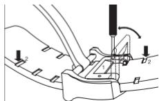
將錶鏈置於一個牢固的底座上，上表面朝上，錶扣完全打開。錶扣外側下方設有緊固扣，其作用是固定錶鏈。
