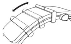
表链上配有金属环(3), 可用于固定表链松散的末端。该金属环可自由调整至所需的位置。
