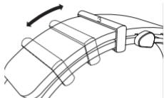
Boş kordon ucunu takmak için bir metal ilmik (3) kullanılabilir. Bu ilmik kordon üzerinde kademesiz olarak ve az miktarda kuvvet harcayarak kaydırılabilir ve istenen pozisyonaya getirilebilir.
