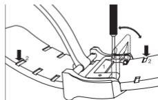
クラスプが完全に開いた状態で、内側を上にして安定した場所にプレスレットを置きます。クラスプ外側の裏面に、プレスレットを固定している留め具があります。留め具のロッキングレバー（1）は、付属の専用工具を2つの穴の一方に差し込み、ロッキングレバーを持ち上げると簡単に開けることができます。開いた状態では、ロッキングレバーはプレスレットに対して直角になります。プレスレットはクラスプの内部で簡単に動きますので、ご希望の長さに調整してください。ロッキングレバーを閉める時は、固定ピンがプレスレットの溝（2）にはまっていることを確認してください。
