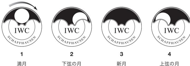
ムーンフェイズ表示は日付機構によって自動的に調整され、常に正しく表示されます。減速比のきわめて精密な計算により、ムーンフェイズ表示の偏差は577年でたったの1日です。
