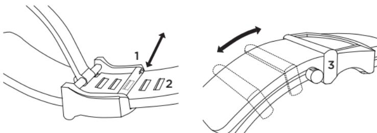
Für die Aufnahme des losen Bandendes steht eine Metallschlaufe (3) zur Verfügung. Diese lässt sich stufenlos und mit wenig Kraftaufwand auf dem Band verschieben und in die gewünschte Position bringen.
