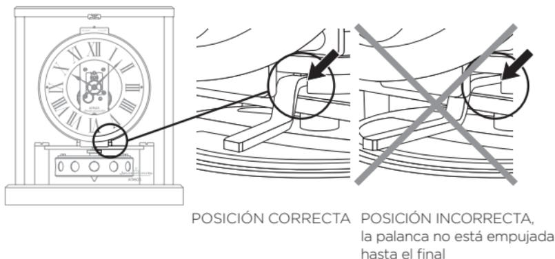
Luego, incline delicadamente el Atmos con el fin de acceder al zócalo del péndulo. Apriete el tornillo de bloqueo debajo del gabinete; cuando entre en contacto con la tuerca debajo del volante, dé 1/4 de vuelta adicional bloqueándolo con la mano.
