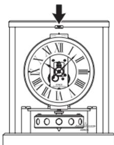
2. Incline levemente la puerta hacia usted. No la incline demasiado mientras aún esté en la ranura del zócalo para evitar dañar la parte inferior del cristal.
