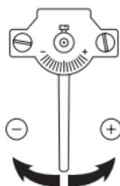
La siguiente tabla le indica la graduación según la cual debe desplazarse la palanca de ajuste en función de los minutos de retraso o de adelanto del péndulo. Según las indicaciones de la tabla, para corregir el adelanto, desplace la palanca hacia la izquierda hacia el signo "-"; para corregir el retraso, mueva la palanca hacia la derecha hacia el signo "+".
