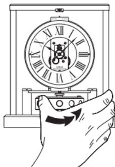
El bloqueo es efectivo únicamente cuando la palanca se encuentra completamente a la derecha, contra la parte metálica.
