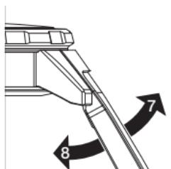
Після кожної заміни ремінця обов'язково перевірте надійність його фіксації, для цього з зусиллям потягніть обидві частини ремінця вгору (7) та вниз (8).
