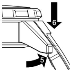
次にブレスレットまたはストラップを元の位置に戻します(5)。これと同時に、ブレスレットまたはストラップをラグに押さえて元の位置に収まるようにします(6)。
