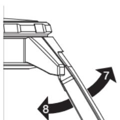
Каждый раз при смене ремешка непременно проверяйте прочность крепления – потянув с усилием обе части ремешка вверх (7) и вниз (8).
