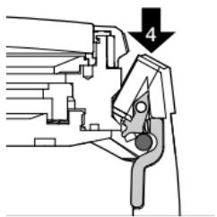
Untuk memasang rantai jam, kaitkanlah lekukan pada sambungan rantai jam ke pin pegas pada casing jam (4).
