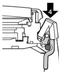
ブレスレットまたはストラップを取り付ける際は、ラグの切り込みをケースのスプリングピンに上から引っ掛けます(4)。
