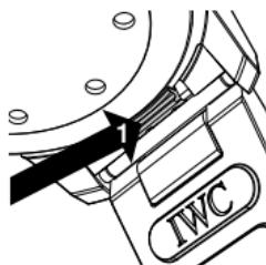
Ваши часы Aquatimer Automatic 2000 оснащены запатентованной IWC системой быстрой смены браслета или ремешка, позволяющей Вам быстро и просто заменить браслет или ремешок без использования инструментов. Для отсоединения браслета или ремешка с усилием нажмите ногтем большого пальца на предохранительный рычажок (1), расположенныйный на внутренней стороне между ушками крепления.
