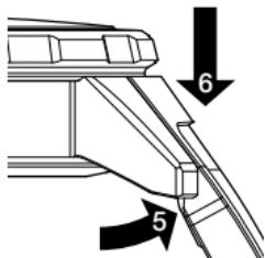
Nyní překlopte pásek ven (5) a zároveň zatlačte zvenčí kolmo na stěžejkovou část pouzdra, aby došlo k zaklapnutí mechanismu (6).
