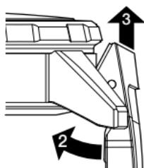
ブレスレットまたはストラップを内側に傾けて(2)、ケースから離すように上側に動かします(3)。
