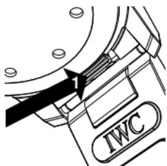
Aquatimer Otomatis 2000 Anda dilengkapi Sistem Ganti Cepat Rantai jam IWC yang dipatenkan dan memungkinkan jenis rantai jam yang disediakan diganti secara mudah dan tanpa peralatan. Untuk melepas rantai jam, gunakan kuku jempol Anda untuk mendorong tuas penahanan (1) di bagian bawah sambungan rantai jam ke arah luar.
