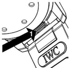
您的海洋時計2000自動腕錶備有專利IWC萬國錶錶鏈快速更換系統，讓您輕鬆快捷更換提供的錶鏈，無需使用工具。若要移除錶鏈，請先用大拇指向外用力按壓錶耳下方的定位桿(1)。
