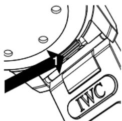
アクアタイマー・オートマティック 2000にはIWCが特許取得した「ブレスレットクイック交換システム」が搭載されています。工具をすることなく、素早く簡単にブレスレットまたはストラップを交換することができます。ブレスレットまたはストラップを外す時は、突起部の裏側にあるロッキングレバーを外側に向けて親指で力強く押します(1)。
