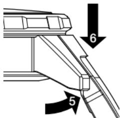
Теперь приподнимите конец браслета или ремешка (5) и одновременно вертикально надавите сверху на крепление для того, чтобы механизм защелкнулся (6).
